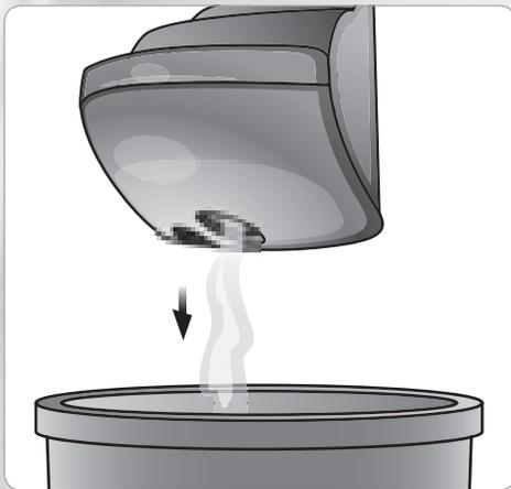
**4.** Retournez votre centrale et ouvrez le bouchon de vidange (22) à l'aide de la clé (23) livrée avec l'appareil. Pour des raisons de sécurité, l'accès à la chaudière est volontairement difficile.
