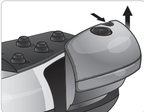
**2.** Enlevez le bouchon (20) en le tournant d'1/4 de tour et remplissez le réservoir amovible (21) avec 0,7 litre maxi.
