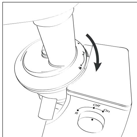
Positionnez la cheminée pour que la languette s'enclenche dans le corps de l'appareil. Tournez la cheminée jusqu'à ce qu'elle soit verrouillée. Les cadenas doivent être alignés avec le corps de l'appareil, complètement à droite.
