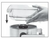
Saisissez le panier-filtre (13) et alignez ses flèches avec celles figurant sur l'entraînement "moteur". Poussez vers le bas jusqu'en butée.
