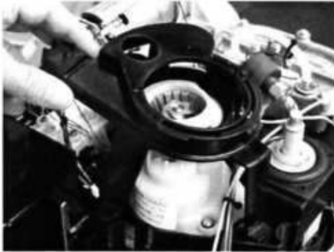
Démontage du support du broyeur
