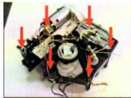
Débrancher les différentes prises de la carte et de la fiche de masse pour retirer la platine technique du dessus de l'appareil
