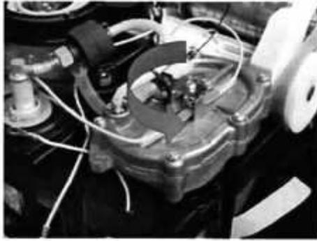
Décrochage du thermobloc en appuyant sur le verrou et tourner le thermobloc
