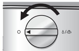
La pompe s'arrête instantanément et le circuit de la buse est fermé.
