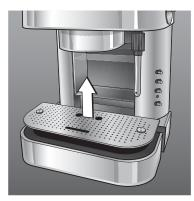
c) Pincez les 2 tiges plastiques servant de butée et se trouvant en partie centrale avant et arrière du bac (9) pour libérez ce dernier. Nettoyez-le sous l'eau chaude et essuyez-le complètement.
