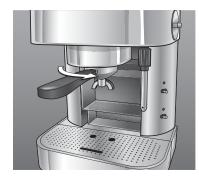
Placez 1 ou 2 tasses (selon le cas) sur la grille reposetasses (12) en la (les) positionnant correctement sous le bec d'écoulement café (15).
