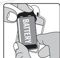
Votre CelluLight fonctionne avec un adaptateur ou une pile. Pour mettre en place la pile, il suffit d'ouvrir le petit compartiment situé sous l'appareil. Utilisez seulement une pile PP3, MN1604 ou 6LR61.
