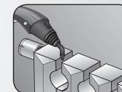
Elle peut être utilisée avec ou sans la buse haute pression (A), avec ou sans le capuchon (B). Elle est particulièrement adaptée au nettoyage des petites surfaces difficiles d'accès (radiateurs, volets...).
