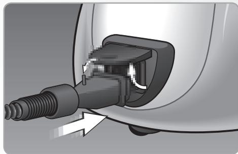
**2.** Avec ou sans tubes rallonges (12), fixez un accessoire (13 à 19) sur le raccordement des accessoires (11), selon l'utilisation désirée.
