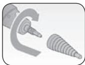
Le capuchon (2) : il peut être appliqué sur le raccordement des accessoires (G) pour protéger son extrémité.
